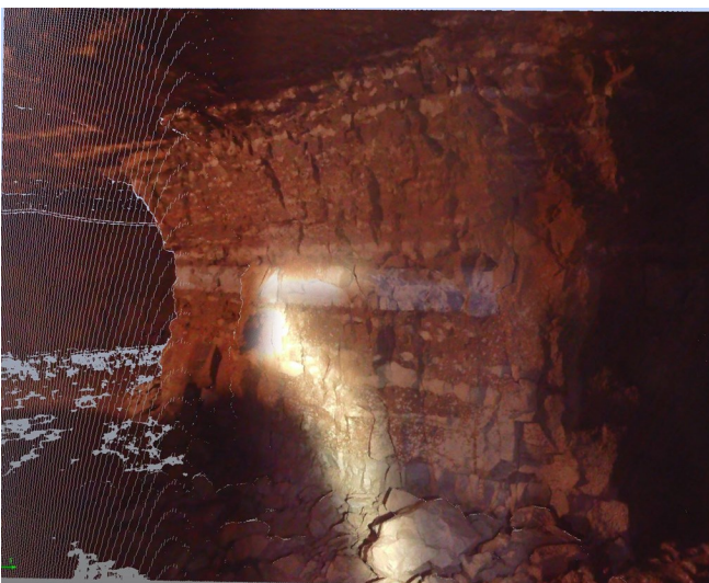
Joonis 6. Staatilise skanneriga tehtud värviline punktipilv, valge C/D vahekiht on tootuskihi keskosas asuv selgelt eristuv ja jälgitav kiht, mida kasutatakse maa-alusel kaevandusel markeeringuna.
